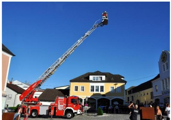
Die Drehleiter Peuerbach wurde durch die Firma Rosenbauer in Karlsruhe gefertigt. Mit dem 5-teiligen Leiterpark, bei dem das letzte Segment mit einem Gelenkteil versehen ist, erreicht man eine Höhe von 32 Meter und hat einen Rettungskorb, den man flexibel an jeden Einsatz anpassen kann.
